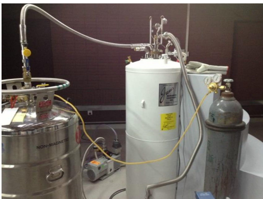
图 11 液氮传输过程示意图
