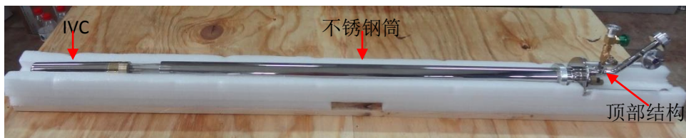
图 4 真空型变温插件
